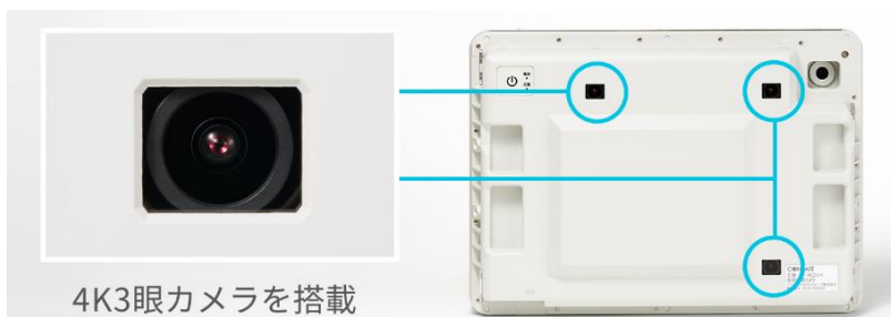
写真2 AIカメラ(配筋検査専用デバイス)
