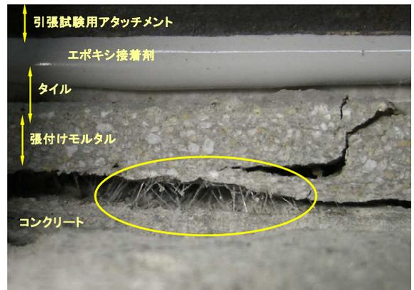
写真4 接着強度試験時に繊維が抵抗している状況例2
