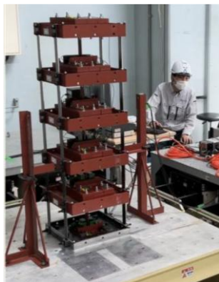
建物模型による振動台実験
