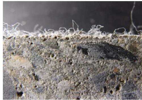
写真4 タイル張り前のコンクリート断面
