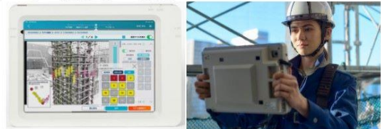
配筋検査システム使用イメージ
