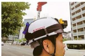
古（いにしえ）から培われてきた勘やコツなどの熟練技能は、生産性向上対策の鍵になるものとわが社では考えている。そこで、技能のアーカイブによる生産能力維持を目的とした、『アイマップシステム』の開発を進めている。技能を定量化するために、独自開発のヘルメットログや通信システムなどのセンシングツールと解析手法で、管理者や施工者の意思決定促進、未熟者の教育訓練ツールおよび災害時の情報収集ツールとして汎用化を目指している。（田村 泰史 / 戦略事業推進部新技術事業化推進室課長）
