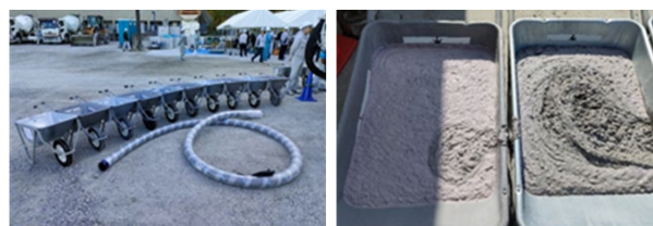
写真-2 筒先試料の連続採取の状況
