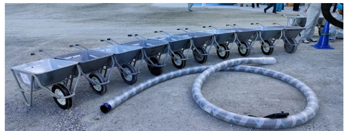
写真-2 筒先試料の連続採取状況
