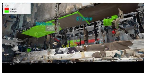
図-3 (AR (拡張現実) 技術とディスプレイ空間に情報を記録するデバイス (ホロレンズ) を活用した) 形状マッピング (上) と計測記録 (下) の事例
