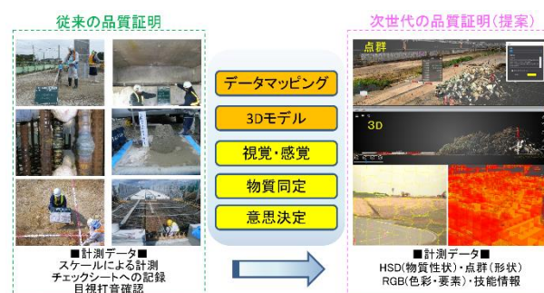
図－6 非接触型施工管理システム
