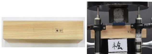
写真-4 部分圧縮向圧縮試験片例と加力状況
