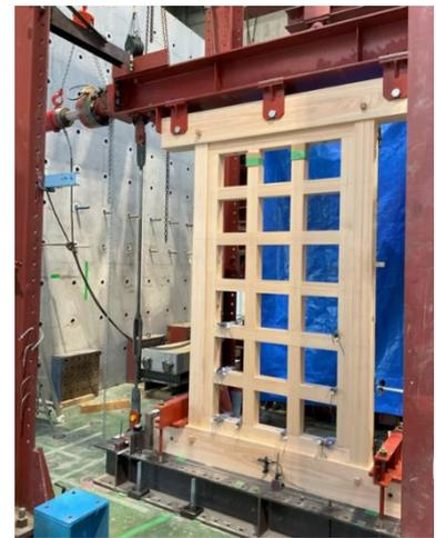
写真-2 試験体（ヒノキ材）の設置状況
