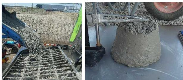
写真-1 BB+FA コンの排出状況とスランプ試験
