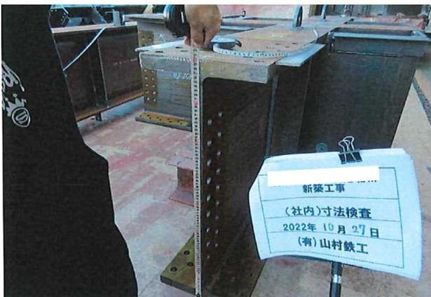
写真 5-3 仕口部寸法検査
