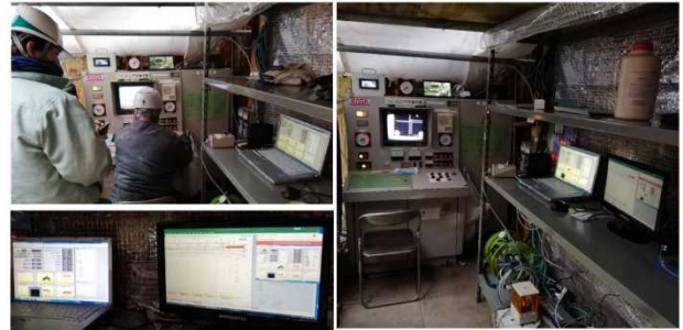
写真-6 通信回線による施工情報の共有（閲覧システム）
