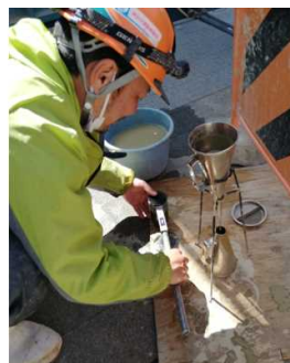
写真-9 泥水性状試験
