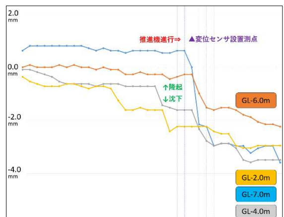
図-7 変位センサによる地盤変状の推移
