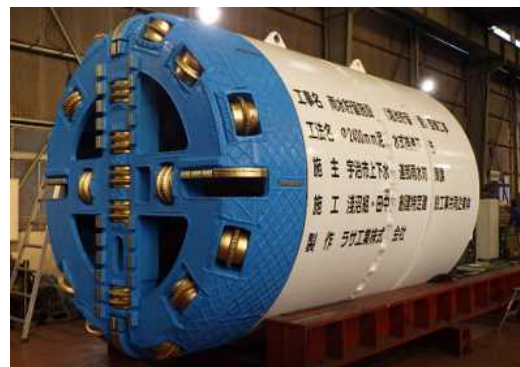
写真-2 本工事の泥水式推進機
