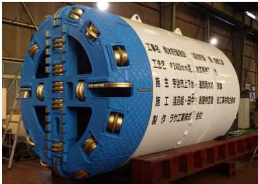
写真-1 本工事の泥水式推進機
