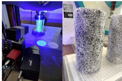
写真－７ DIC 計測状況およびコア供試体ランダム模様
