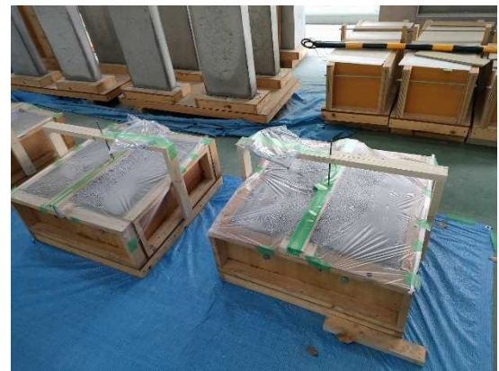
写真－4 湿潤養生状況
