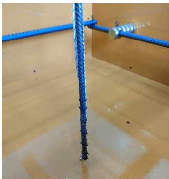
写真－2 配筋およびK熱電対設置状況
