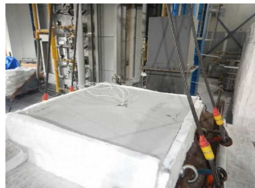
写真－５ 加熱試験体（加熱炉）セット状況
