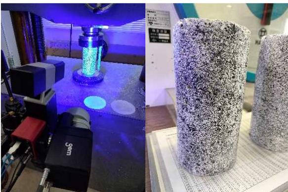
写真-1 DIC計測状況およびコア供試体ランダム模様
