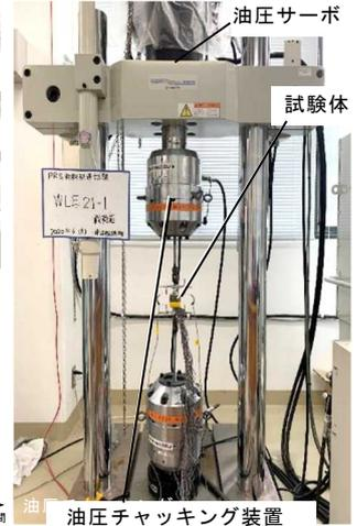
写真-9 引張試験装置
