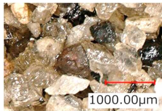
写真-2 PRS のポーラス機構
