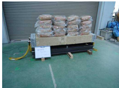
写真-7 ウマ目地載荷試験
