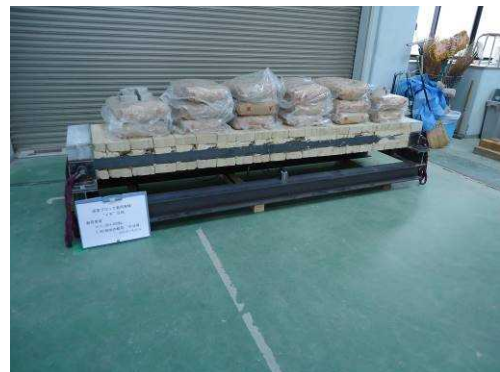
写真-6 イモ目地載荷試験
