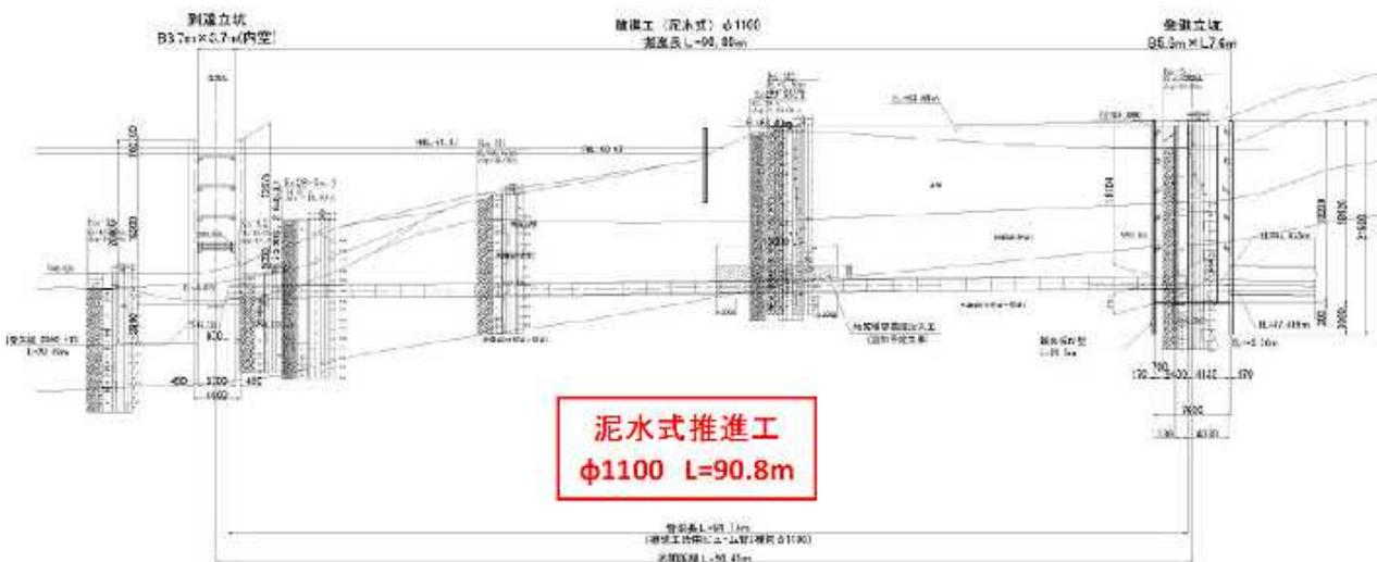
図－1 泥水式推進工 縦断面図
