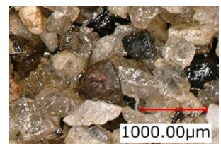
写真 1-2 PRS のポーラス機構
