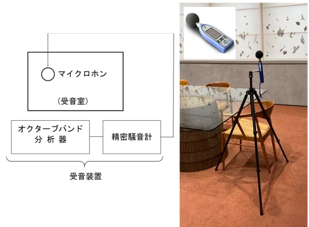
図 2 測定装置の構成と実際の機器設置状況
