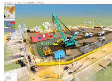
図-6 VR モデル (資機材配置操作、工事3)
