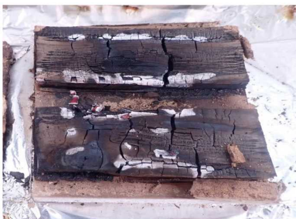
写真-7 発熱性試験後 (SW100-2SP) : 表層土解体状況 →名古屋支店 RN. で採用された標準仕様
