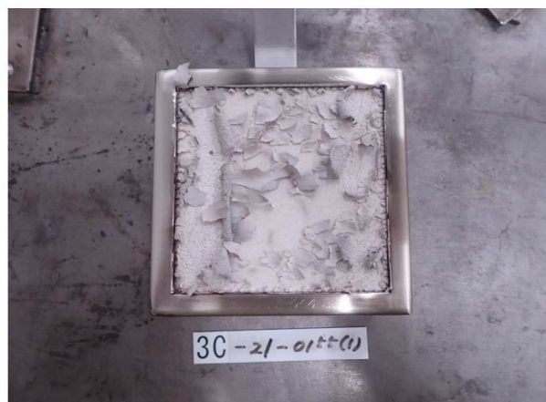
写真-4 発熱性試験後 (PB0) : ボード表し
