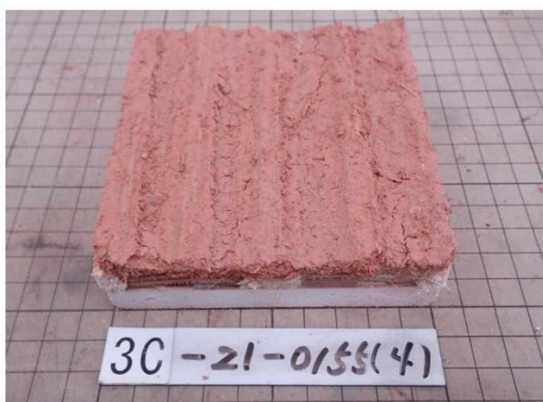
写真-5 発熱性試験前 (SW100-2SP) : 木摺入り、指掻き仕上 →名古屋支店 RN. で採用された標準仕様
