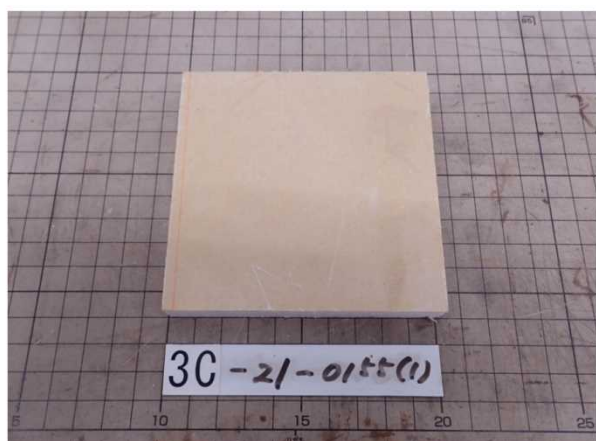
写真-3 発熱性試験前 (PB0) : ボード表し
