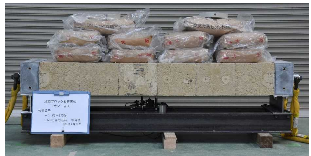
(馬目地壁試験体)
