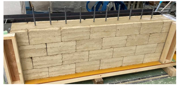
(馬目地壁試験体)
