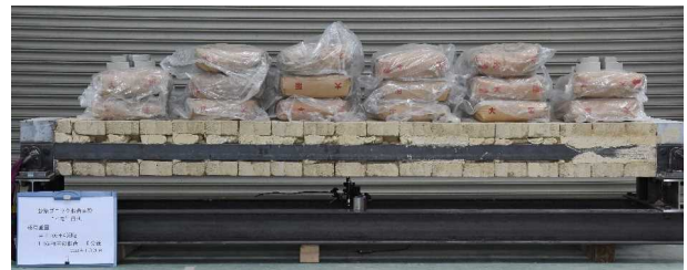
(芋目地壁試験体)
