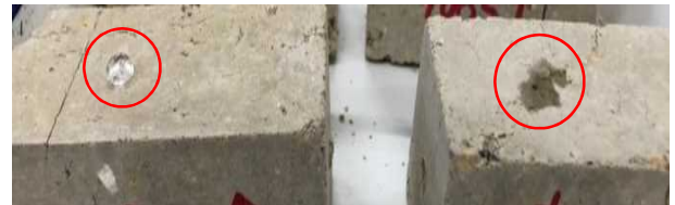
写真-3 シラン系の撥水状況
