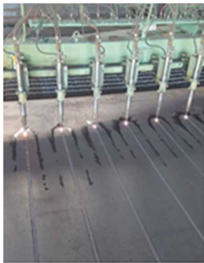
プレート切断
