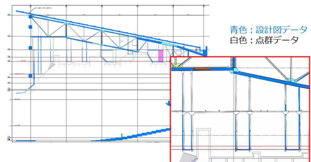
図-20 既存部材のチェック (点群データと設計データの照査)
