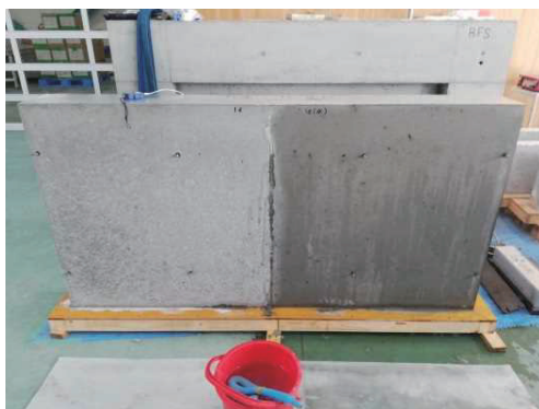
写真－1 模擬壁試験体の状況（右側は散水）
