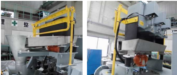
写真-3 SF 自動投入装置
