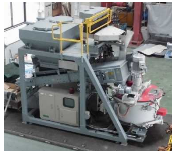
写真-1 移動式バッチャープラント
