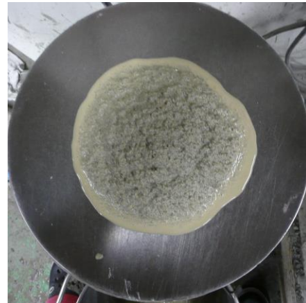
図 2-5 ワーカブルではないモルタルのフロー試験結果の例
