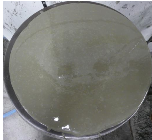
図 2-2 ワーカブルではないセメントペーストのフロー試験結果の例
