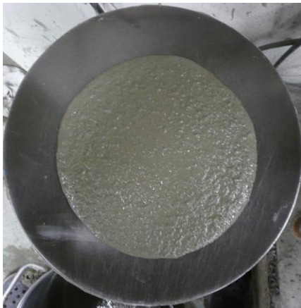
図 2-4 ワーカブルなモルタルのフロー試験結果の例（M2-①）
