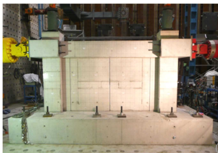
写真-1 せん断破壊型試験体例（加力前）
