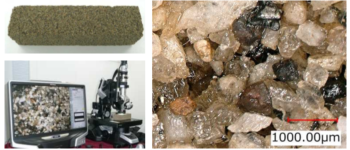
写真-5 PRS 充填材（珪砂 4号：粒径 0.5～1.0mm）
