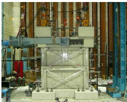
写真-2 曲げ破壊型試験体例（加力前）
