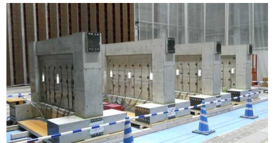
写真-3 収縮試験体の保管状況（屋内）
