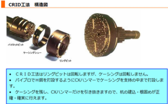
図-6 CRID 工法構造図
