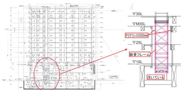
図-2 鉄骨EVシャフトの断面図
