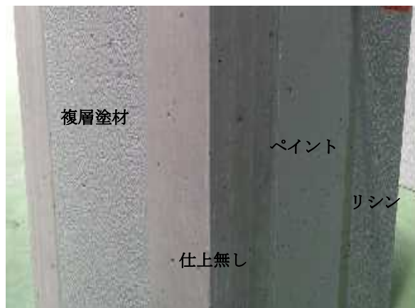
写真－１ 各種仕上材を塗布したコンクリート試験体の例
