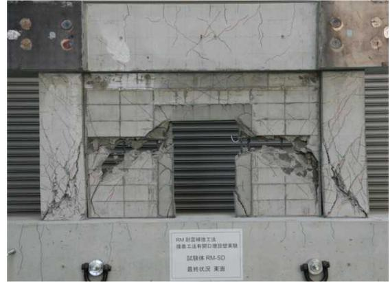
写真-1 試験体最終状況
