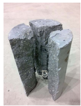
写真－3 割裂破壊状況
