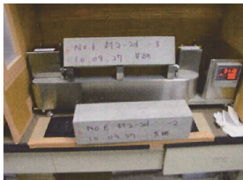
写真-1 (上) 収縮低減剤塗布状況 (下) 長さ変化測定状況
