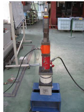
写真-3 引抜き試験状況
