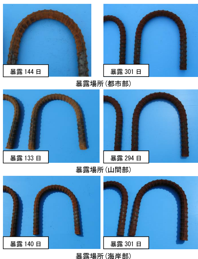
写真-4 暴露場所ごとの錆進行状況比較写真 (試験体 B、防錆剤無塗布)
