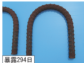
写真－３ 錆進行状況（無塗布鉄筋）
