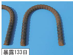
写真－３ 錆進行状況（無塗布鉄筋）
