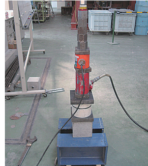
写真－２ 引抜き試験状況
