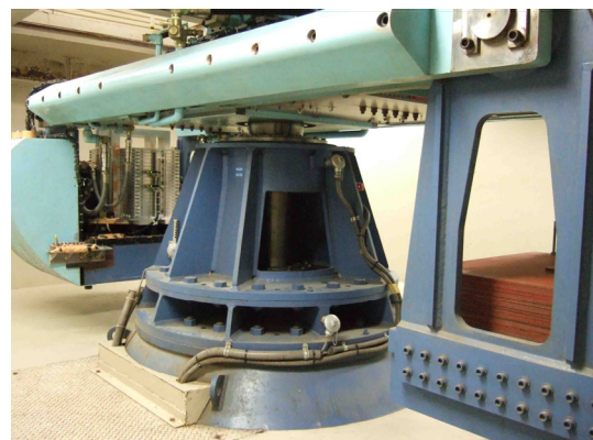
写真-1 動的遠心載荷実験装置の全景
