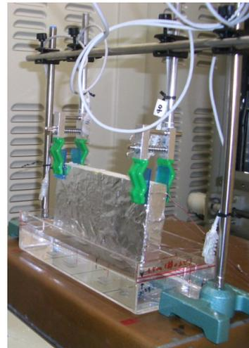
写真-1 吸水実験の状況
