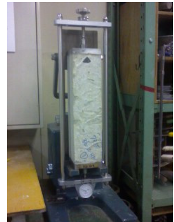
写真-2 長さ変化率の測定 (JIS A 6202 B 法)
