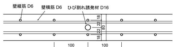
図-3 試験体壁断面図
