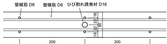
WP80R20 (壁筋比0.8%, 誘発材率20%, 総断面欠損率35%)
