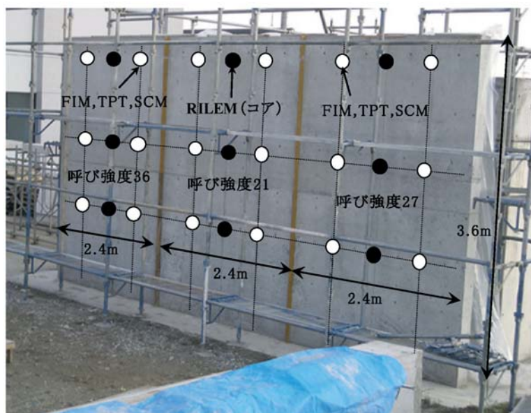
写真-1 実大RC壁と各種の試験位置
