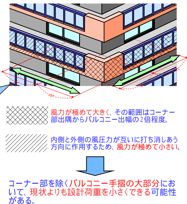
図 - 1 バルコニー手摺における風力の概要
