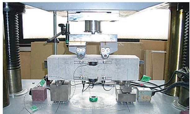
写真－１ 曲げ試験状況
