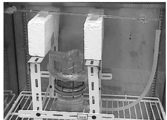
写真-3 透水係数の測定装置
