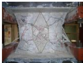
試験体の最終破壊状況
