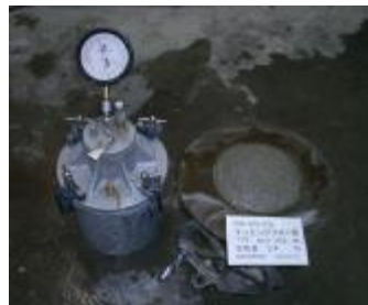
ハイブリッド型繊維補強セメント系複合材料 フロー試験
