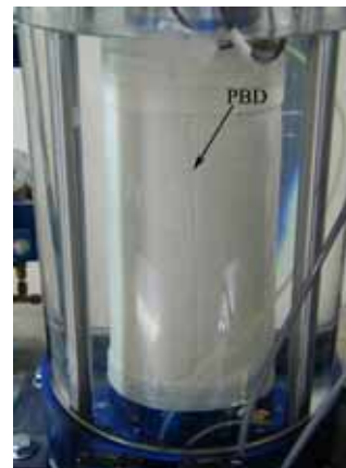
図 - 2 中空ねじりせん断試験の状況
